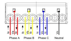
Per un'installazione >70 kWc, dovrai utilizzare dei trasformatori per misurare la corrente. Il rapporto di trasformazione deve essere indicato al momento dell'ordine del materiale. Dovrai poi connettere ogni trasformatore agli ingressi Fase A, B e C e, infine, alimentare il contatore connettendo le fasi e il neutro agli ingressi Va, Vb, Vc e Vn.
