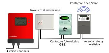
Il contatore può essere installato su un muro, su un pannello elettrico o all'interno di un involucro.
